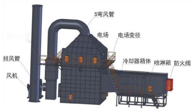
图 6.2-3 “水喷淋+间接冷却+静电净化”设备示意图
